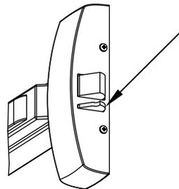
Si le dispositif de sortie est équipé d'un pêne dormant, le CX-EPD1299L doit être monté de manière à ce que le pêne dormant ne pénètre pas dans la cavité du pêne de la gâche. Positionnez la gâche de manière à ce que le pêne dormant repose contre la face de la gâche.
