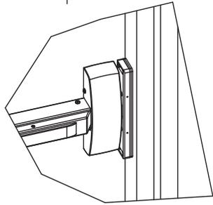
L'axe de la gâche (mâchoires) de la (mâchoires) de la gâche de jante DOIT être alignée avec l'axe du loquet de la barre d'arrêt.
