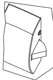
Tenir compte de la liberté de mouvement du pêne du dispositif de sortie de secours et de la gâche (mâchoires). Veillez à ce que le pêne du dispositif de sortie et la gâche (mâchoires) de la gâche électrique puissent se déplacer librement et facilement pour fonctionner ensemble, avec un minimum de frottement. Une petite quantité de lubrifiant à base de silicone sur le loquet et les mâchoires de la gâche améliorera le fonctionnement, mais veillez à ne pas trop pulvériser.
