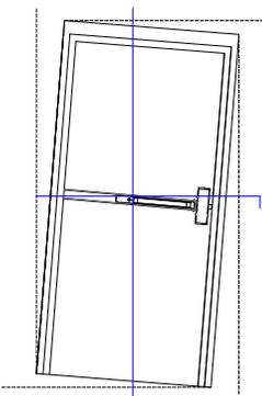
Vérifiez l'écart entre la porte et la butée de l'encadrement. Une différence de 1/4" est très courante et peut être compensée par la gâche - SI ELLE EST INSTALLÉE CORRECTEMENT.
