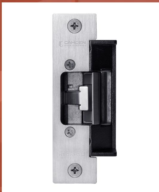
Les gâches ANSI de grade 1 CX-ED1079 (profil bas, course de 13 à 16 mm (1/2 à 5/8 po) et CX-ED1079D profondeur standard, course de 16 à 19 mm (5/8 à 3/4 po) offrent une performance « universelle » avec mode sélectionnable 12/24 V CA/CC, fonctionnement à ouverture ou à fermeture en cas de panne de courant et réglage horizontal du corps de gâche. Surveillance de verrou en option sur les deux modèles.
